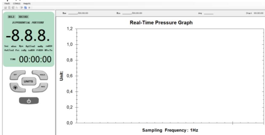
• Иконки в левой части интерфейса ПО функционально полностью соответствуют кнопкам на приборе. Управление прибором возможно как из интерфейса ПО, так и кнопками на приборе.
